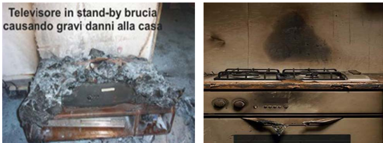
Fig. 1: Innesco in un televisore e su un piano cottura
